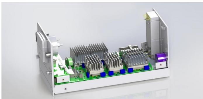
En las tablillas PCB y los componentes electrónicos de ésta, circula corriente eléctrica, lo que hace que de manera natural se genere calor en su operación. La correcta disipación de calor de las zonas o componentes críticos es necesaria para
