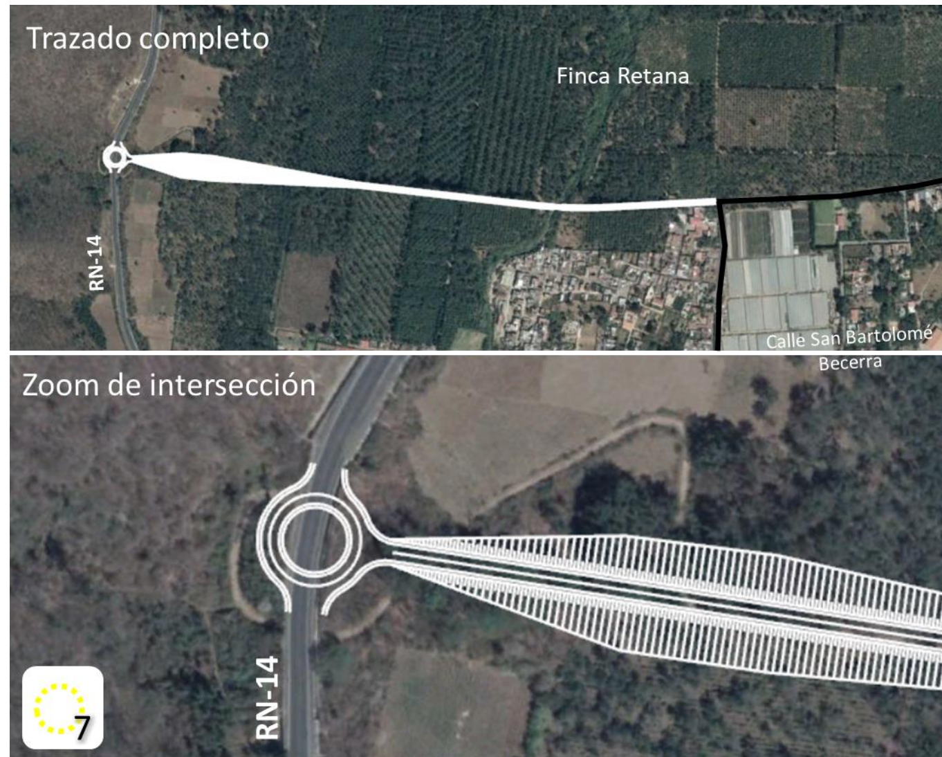
Figura 50 Propuesta de intersección entre la carretera desde San Bartolomé Becerra y la RN-14
