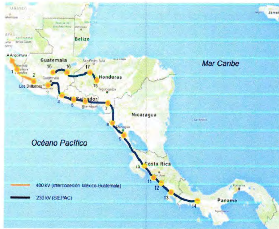
Ilustración 1 Sistema Regional - interconexión eléctrica MER
